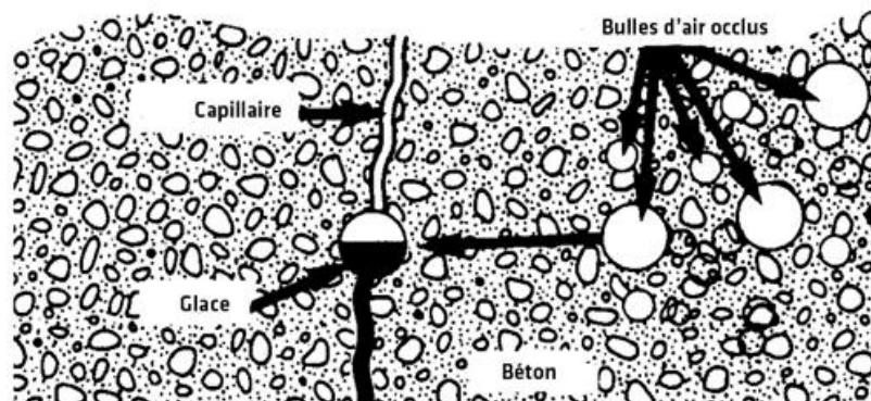
*Blocage des remontées capillaires et protection au gel*
